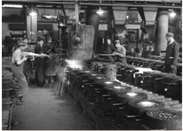
Ulivanje serijske litine v strojni livarni Železarne Ravne leta 1959 (Foto: KPM Muzej Ravne na Koroškem)
