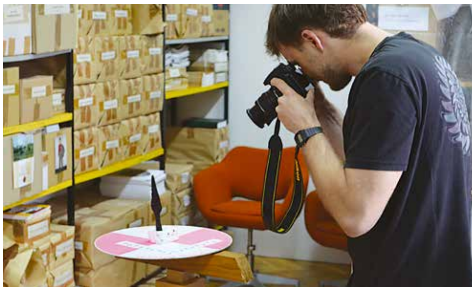
Slika 4: Zajemanje fotografij predmeta za namen izdelave 3D modela – fotogrametrija. Na fotografiji geodet Jernej Vipavec (foto: Kristjan Husič).
